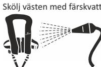
Obs! På modeller med automatisk utlösning, avlägsna den automatiska utlösningmekanismen innan rengöring av flytvästen.
