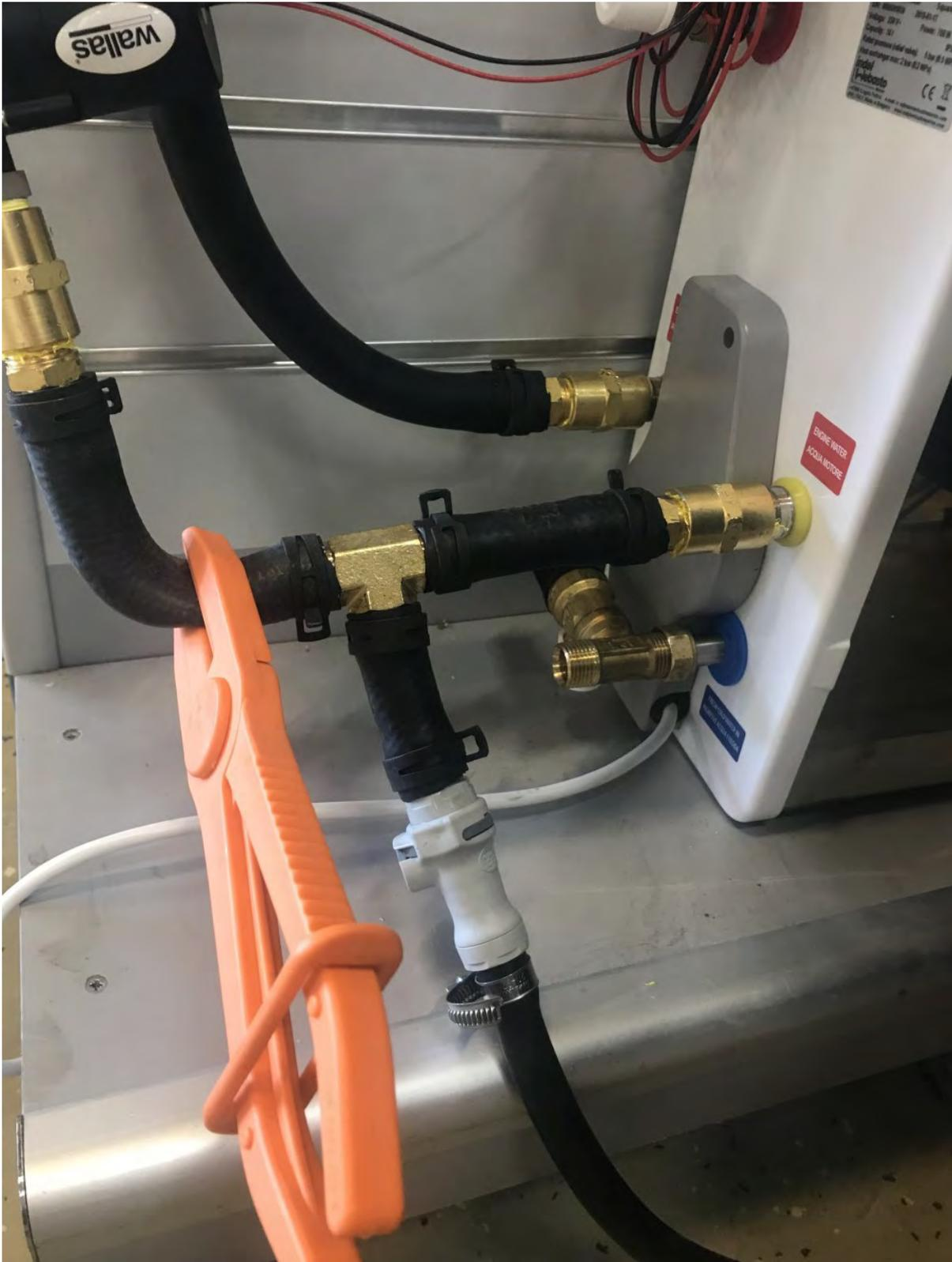
5) Demontieren Sie den Befüllschlauch und verschließen Sie das offene Ende des T-Stücks.
