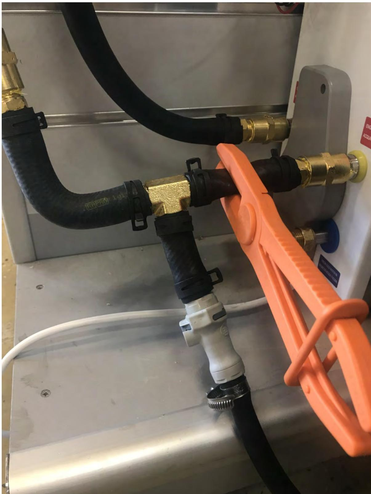
3) Befüllen Sie das System mit der Kühlmittelpumpe, bis sich der Ausgleichsbehälter gefüllt ist.
