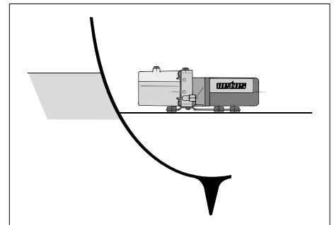
Der Verschlussdeckel oder der Anschluss der Ausgleichsleitung\* hat sich immer an der Oberseite, und zwar **am höchsten Punkt**, zu befinden.
