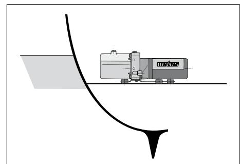
Il tappo di riempimento o il raccordo della linea di compensazione\* devono trovarsi sempre sopra la pompa, **nel punto più alto possibile**.
