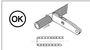
Ne jamais couper le tuyau avec une scie (les débris de sciure provoquent des défaillances du système hydraulique) ni avec une pince (qui déforme le tuyau).
