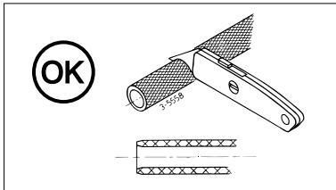
Kort de slang nooit af door middel van zagen (zaagsel in het hydraulisch systeem geeft onherroepelijk problemen) of door middel van knippen (de slang wordt te veel vervormd).
