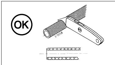
No acortar nunca el tubo con una sierra (serrín en el sistema hidráulico daría inevitablemente problemas) ni con unas tenazas (el tubo se deformaría demasiado).
