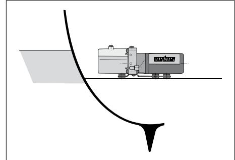
El tapón de relleno o la conexión para el tubo de nivelación\* siempre se han de encontrar en el lado superior, en el punto más elevado.
