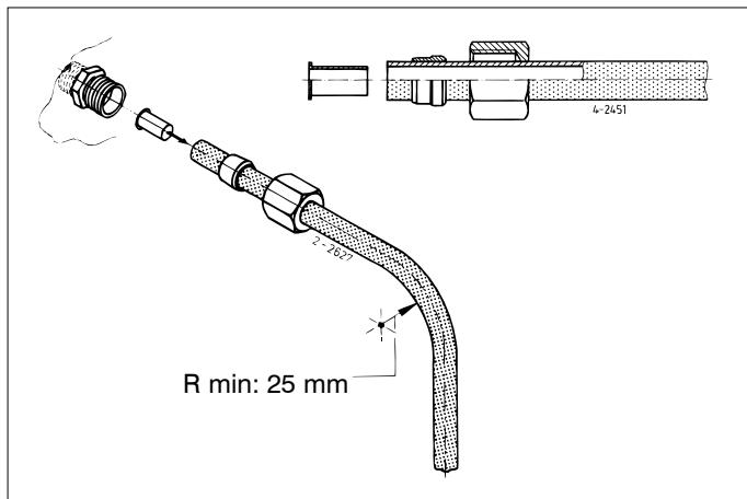
Enfiler, après avoir coupé la conduite nylon, le manchon de serrage et l'anneau de coupe sur la conduite et placer la douille de soutien dans la conduite.
