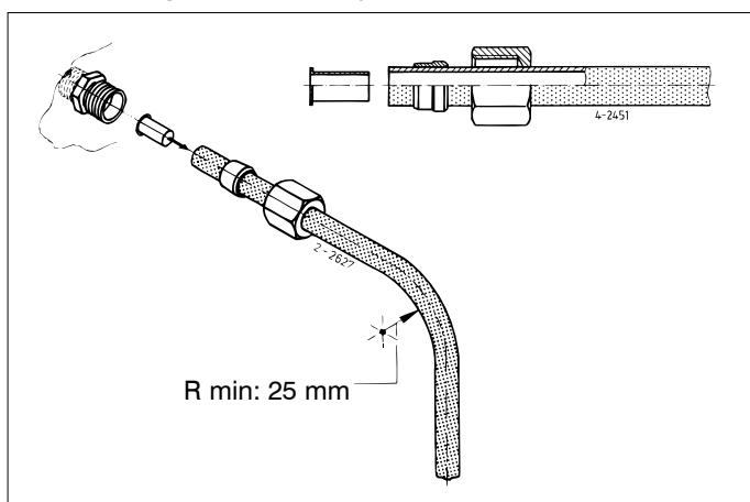
tubo e montare la boccola all'interno del tubo.
