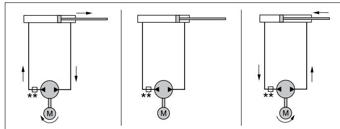
\*\* Kupplung mit eingebauter Drosselung
