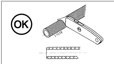
Non accorciare mai le condutture o tubature segando (l'entrata di segatura nel sistema idraulico causa seri problemi), o tagliando via la parte eccedente con una tenaglia (eccessiva deformazione del tubo).
