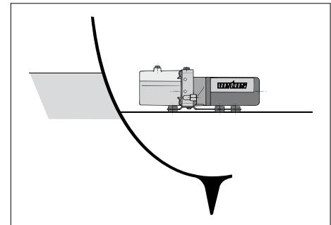
De vuldop of de aansluiting voor de vereffeningssleiding\* dient zich altijd aan de bovenzijde, **op het hoogste punt**, te bevinden.
