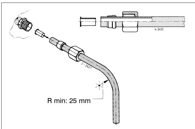
Plaats na het afsnijden van de nylon leiding de wartelmoer en de snijring op de leiding en plaats de steunhuls **in** de leiding.
