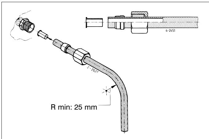
Bringen Sie nach dem Abschneiden des Nylonrohrs die Überwurfmutter und die Druckbuchse auf dem Rohr an und stecken Sie die Stützbuchse in das Rohrende.
