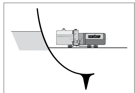
Le bouchon de remplissage ou le raccordement de la conduite de compensation\* doit toujours se trouver à la partie supérieure, au point le plus élevé.
