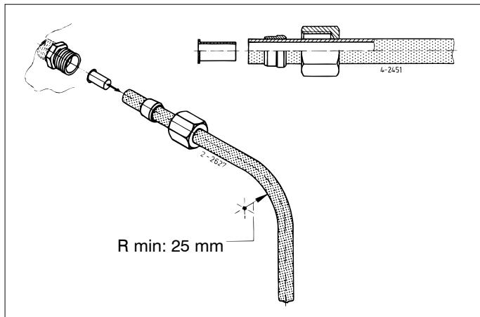
Cortado el tubo de nailón rígido, colocar sobre él la tuerca con rosca interior y la arandela de presión, e introducir en el tubo la funda de soporte.
