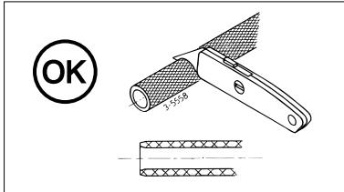
Kürzen Sie den Schlauch niemals durch Sägen (Sägemehl im hydraulischen System verursacht irreparable Schäden) oder Kneifen (der Schlauch wird zu sehr verformt).
