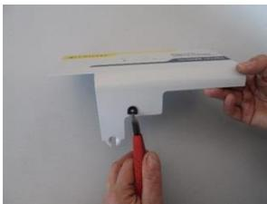
Einsetzen der Gummi-Kabeltülle
