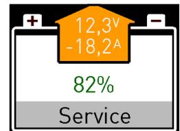
Mit einem kurzen Druck auf das Batterie-Symbol kann zwischen den Anzeigen – **Kapazität in %** – **Kapazität in AH** - **Restzeit** – **Batterie-Temperatur** – gewechselt werden. Alternativ erscheinen folgende Fehlermeldungen:
