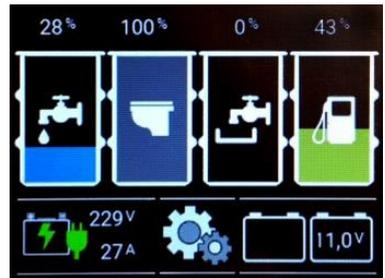
Der **Batterie-Bildschirm** zeigt die über den Shunt gemessene Haupt-Batterie links an. In dem Pfeil werden der aktuelle Strom und die Batterie-Spannung angezeigt. Ist der Pfeil grün wird die Batterie geladen, ein roter Pfeil zeigt die aktuelle Entladung an.
