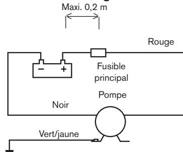
Les autres équipements électriques, comme un coupe-circuit, doivent être installés entre la pompe et le fil positif (+) de la batterie (sur le fil rouge).
