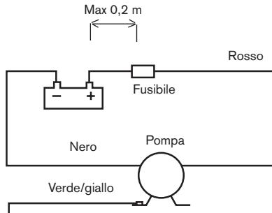
Altre installazioni elettriche, ad esempio commutatori, interruttori automatici, ecc., devono essere installati tra la pompa e il positivo (+) della batteria (filo rosso).
