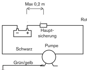
Weitere elektrische Komponenten, z.B. Schalter und Sicherungsautomat, müssen zwischen der Pumpe und der positiven (+) Klemme der Batterie (am roten Kabel) installiert werden.
