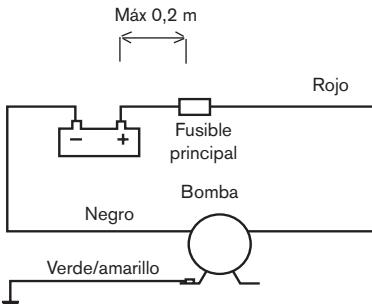
El resto de los dispositivos eléctricos, es decir, el interruptor, el conmutador de circuito, deberán instalarse entre la bomba y el polo positivo de la batería (en el cable rojo).
