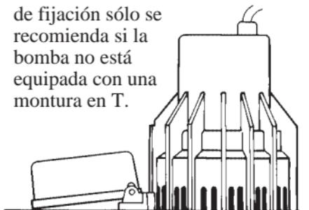
El AS888 debe instalarse siempre paralelo a la quilla con el interruptor flotante apuntando a popa. No instalar nunca el AS888 a nivel inferior al de entrada de la bomba de sentina.
